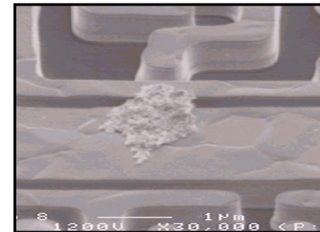
ショート故障箇所
